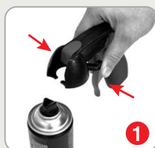
1 Разжать крепление пистолета одновременным нажатием на рычаги крепления
