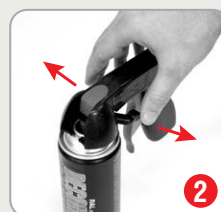
2 Надеть пистолет на баллон и отпустить рычаги. Проверить надёжность крепления
